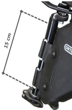
Distance écessaire pour montage de Seat-Pack 16,5 L
