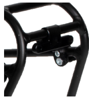
Préparation pour l'option lumière arrière (lumière non incluse) Distance des trous: 50mm
